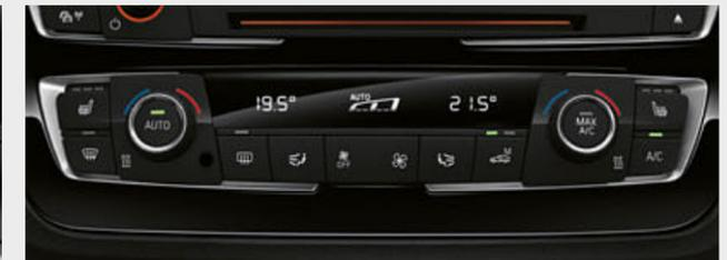
■ 2ゾーン・オートマチック・エア・コンディショナーは自動的に室内温度の維持と風量調節を行います。花粉や粉塵などの侵入を防ぐマイクロ・フィルター付。運転席と助手席で個別に温度設定が可能。一定以上の大気中の有害物質を感知すると自動的に内気循環モードに切り替わるAUC機能付です。
