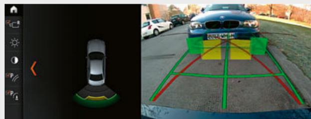
■ パーク・ディスタンス・コントロールは車両の前方や後方にある障害物までの距離を信号音とビジュアル表示で知らせ、狭いスペースでの駐車や車庫入れをサポートします。リヤ・ビュー・カメラは、車両後方の障害物や歩行者をコントロール・ディスプレイに表示します。予想進路表示機能により、目標とする駐車スペースに十分な広さがあるかを確認することができます。
