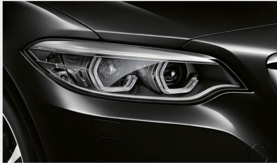
■ ロービーム、ハイビーム、フロント・ターン・インジケータにもLEDを使用したアダプティブLEDヘッドライトには、BMWセレクトティブ・ビーム、デイトタイム・ランニング・ライト、コーナリング・ライト、ハイビーム・アシスタントが含まれます。自然光に近い光が前方の路面を均一に照射し、視認性を向上。暗闇を走行する際の疲労を軽減します。4つのライト・エレメントを備えた伝統的なデザインで、夜間でもひと目でBMWであることを認識させます。
