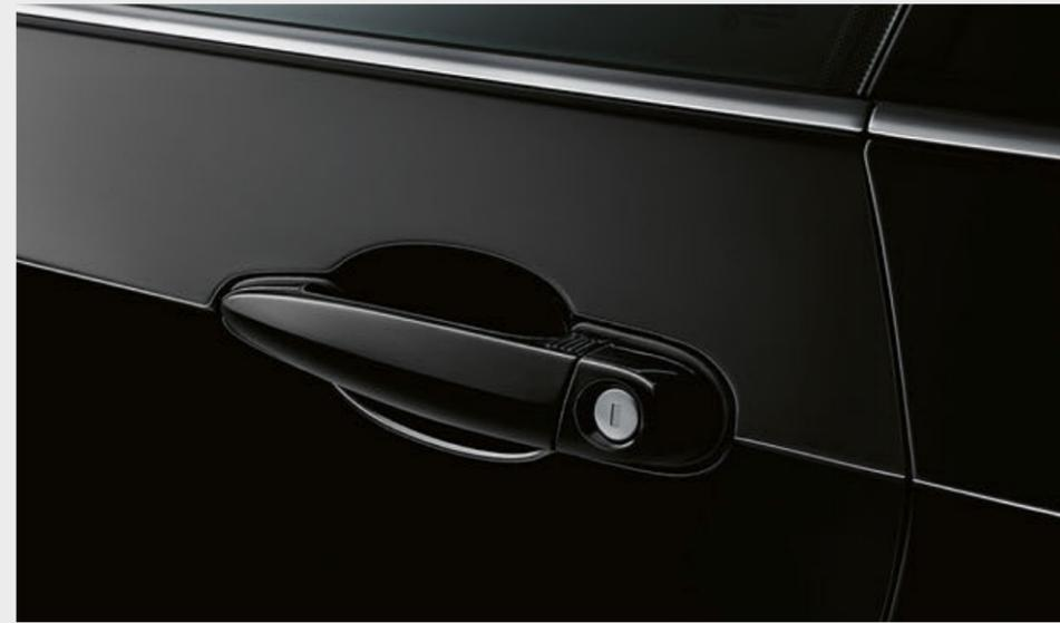
■ コンフォート・アクセスはリモート・コントロール・キーをポケット、ブリーフケース、ハンドバッグなどに入れたまま、ドアのロック/ロック解除、さらにエンジンの始動/停止もできるシステムです。
