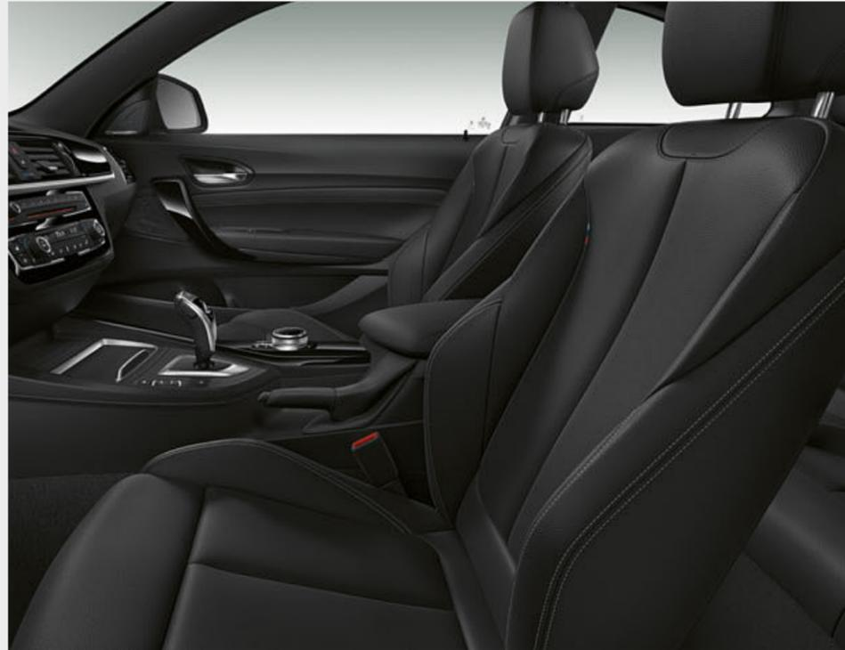
\* スポーツ・シート(運転席&助手席)は電動調節式サイド・サポート付シートバックによって乗員をしっかりホールドします。バックレストの角度、シートの前後、角度、高さ調節が可能で、大腿部を支えるサイ・サポート(マニュアル調節式)も装備。
