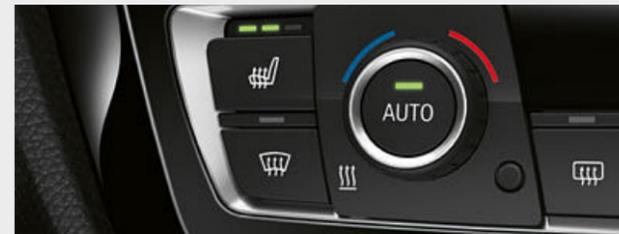
■ フロント・シート・ヒーティング(運転席&助手席)は、寒い季節にシート座面やバックレストを素早く快適な温度に温めます。3段階制御式。
