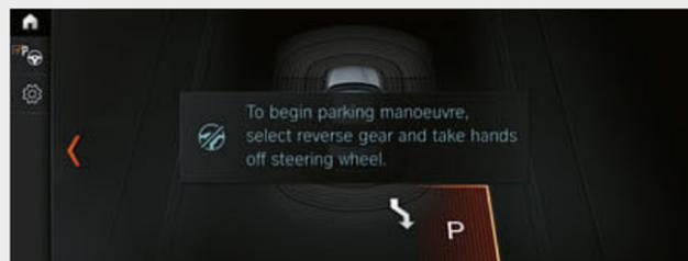
■ パーキング・アシストは路上での縦列駐車をサポートするシステムです。システムが駐車可能なスペースがあるかどうかを測定し、十分なスペースがある場合は、ドライバーに代わり、ステアリング操作を自動的に行います。ドライバーは、音によるガイダンスとコントロール・ディスプレイに表示される指示に従ってアクセル・ペダルとブレーキ・ペダルを操作するだけで、簡単に駐車することができます。
