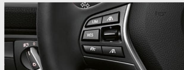
□ ステアリング・ホイール左側に、アクティブ・クルーズ・コントロールの操作系統を配置。ドライバーは運転に集中できるため、安全性がいっそう向上します。
